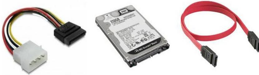
Fixer le disque dans son logement, raccorder le câble d'alimentation et le câble Sata.
